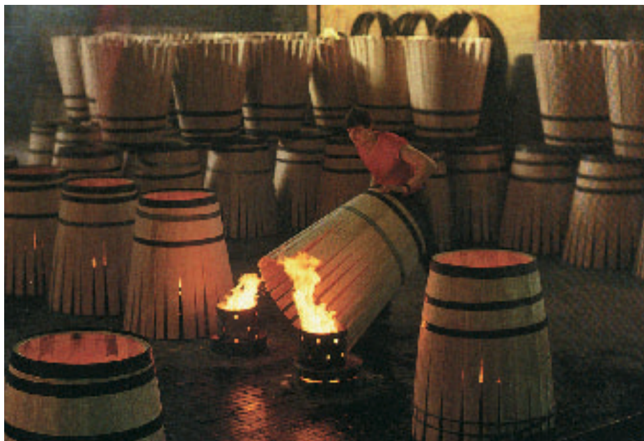
Abb. 5: Feuerung der Fässer, damit das Holz biegsam wird.
