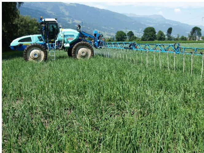
Abb. 3: Sehr gute Anlagerung der Pflanzenschutzmittel mit der Droplegtechnik in Zwiebeln. Bei hohem Blattbestand hat sich die Aufteilung der Spritzbrühe auf 1/3 von oben über die Düsen des Feldbalkens und 2/3 über die Droplegs bewährt.
