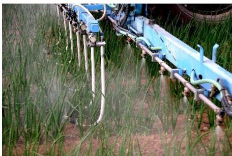
Foto 13: Kombiniertes Einsatz von Droplegs und Feldbalken in Zwiebeln (Foto: J. Rüegg, Agroscope).
