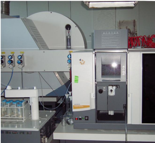
Figure 5. Détermination de divers éléments par spectrométrie en absorption atomique (AAS) (photo: Diane Bürge, Agroscope).
