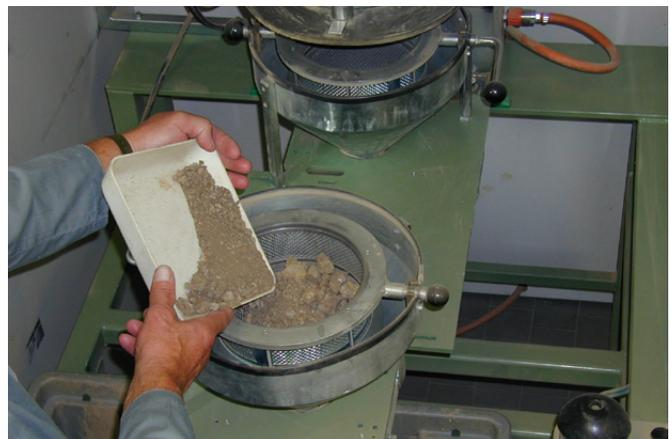
Figure 3. Préparation des échantillons de terre pour l'analyse en laboratoire: tamisage à 2 mm pour séparer la terre fine du squelette (photo: René Flisch, Agroscope).
