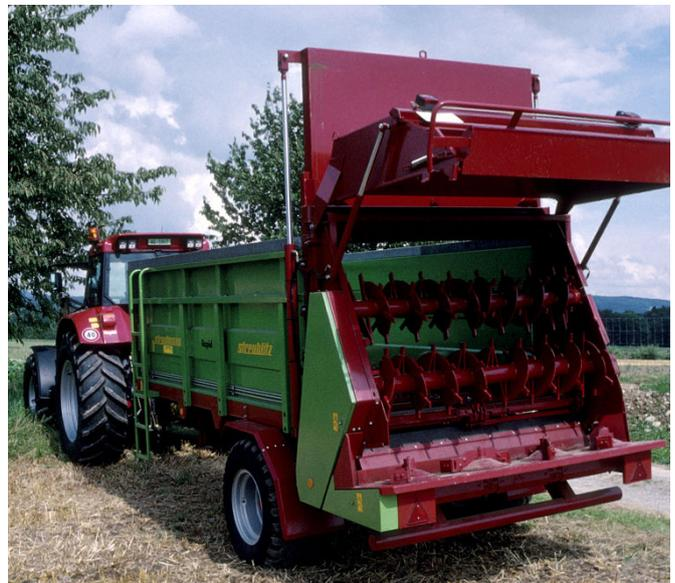
Abbildung 2 | Miststreuer mit zwei liegenden Walzen (Foto: Agroscope).
