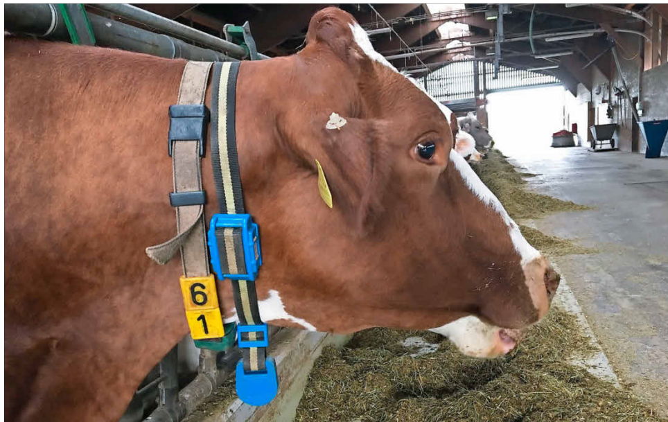
Der Sensor am Halsband erfasst die Wiederkäutätigkeit und die Brunst der Kühe. Daten werden wie von einem Mobiltelefon direkt ins Internet gefunkt. Die Batteriebensdauer soll über zwei Jahre betragen. (Bilder: zvg)
