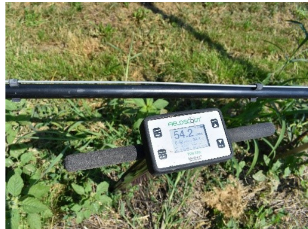
Abbildung 4: Messung des Bodenwassergehalts mit dem mobilen Messgerät TDR350. In diesem Beispiel weist der Boden einen Wassergehalt von 54.2% auf.
