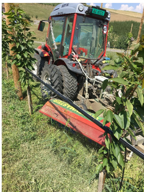
Abbildung 1: Zur Kontrolle der Vegetationshöhe wurde in zwei Verfahren das Fadengerät «Greenmaster» angewendet.
