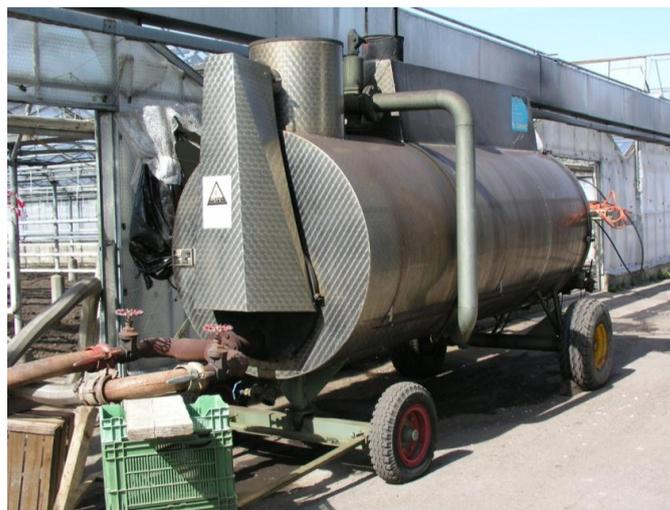
Figura 1: Disinfezione a vapore del suolo: telo zavorrato con tubo per il trasporto del vapore ad elevata temperatura (a sinistra); generatore mobile di vapore posizionato all'esterno della serra (a destra) (Fotografie: Reinhard Eder, Agroscope).
