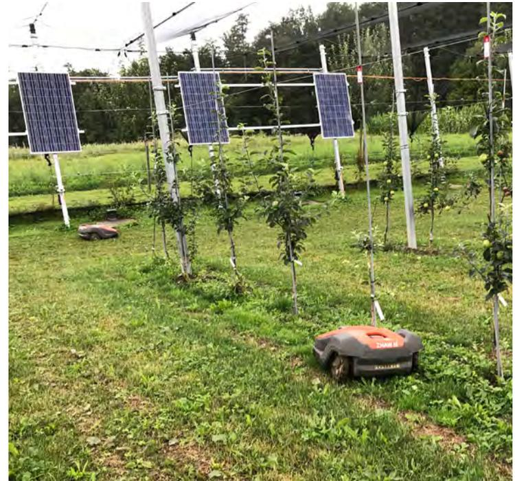
**Abb. 33: Regulierung der Beikräuter mit dem Mähroboter**
