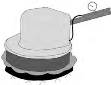
**Abb. 31: Düsenkopf für das Wasserhochdruckverfahren**
