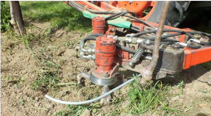
**Abb. 8: Krümmler mit hydraulischer Stammauslenkung**
