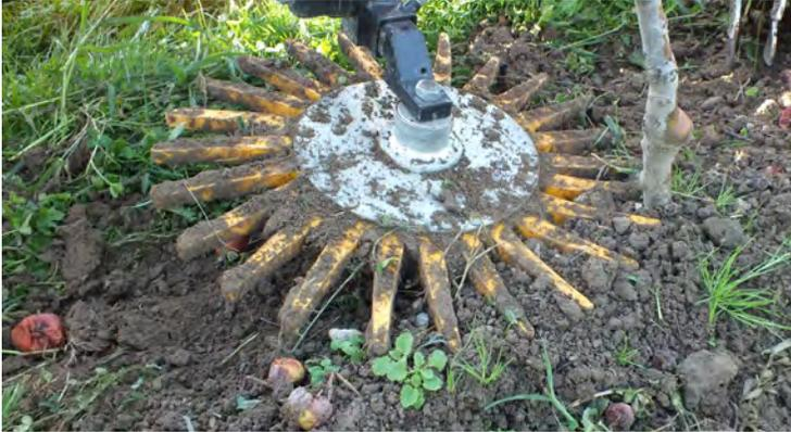
**Abb. 7: Fingerhacke ohne Auslenkung zur Bearbeitung des Zwischenstammbereichs**
