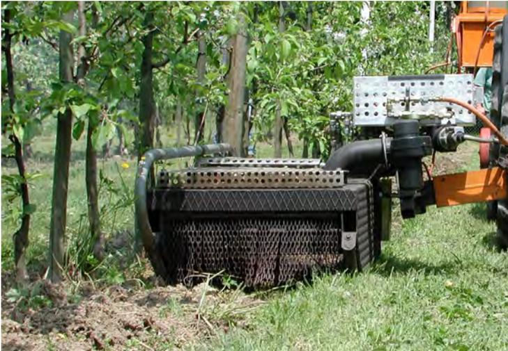
**Abb. 27: Behandlung des Baumstreifens mit einem Abflammgerät mit direkter offener Flamme**
