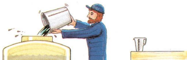
$$\text{Débit des buses} = \frac{\text{vitesse (km/h)} \times \text{largeur de travail (m)} \times \text{volume total à pulvériser (l/ha)} \times 2 \text{ minutes}}{600}$$
