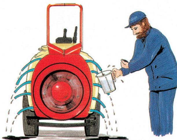
$$\text{Débit des buses} = \frac{\text{vitesse (km/h)} \times \text{largeur de travail (m)} \times \text{volume (l/ha)}}{600 \times \text{nombre de buses ouvertes}}$$
