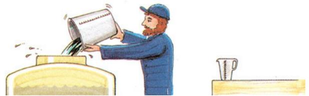
**Berechnung:** Durchfluss aller Düsen 1/2 min
