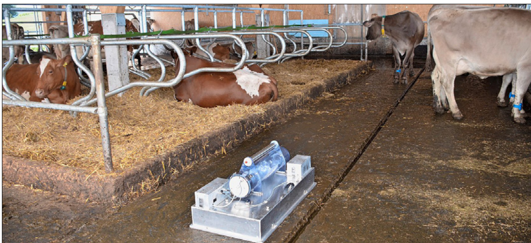
Mit einer durchströmten Haube wird Luft in einen Probenbeutel gesaugt. (Bild: Agroscope)
