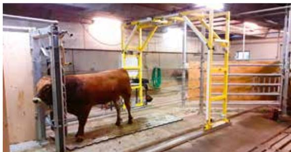
Scan 3D de l'animal vivant grâce au dispositif Morpho 3D
