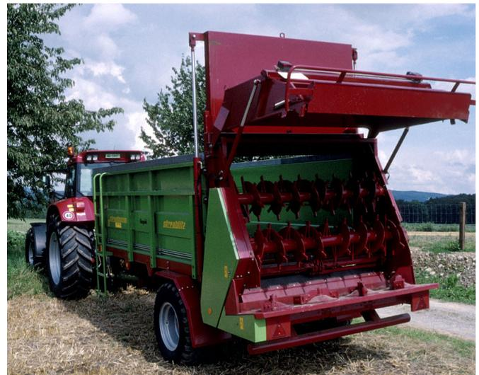
Figura 2. Spandiletame munito di due rulli orizzontali (fotografia: Agroscope).
