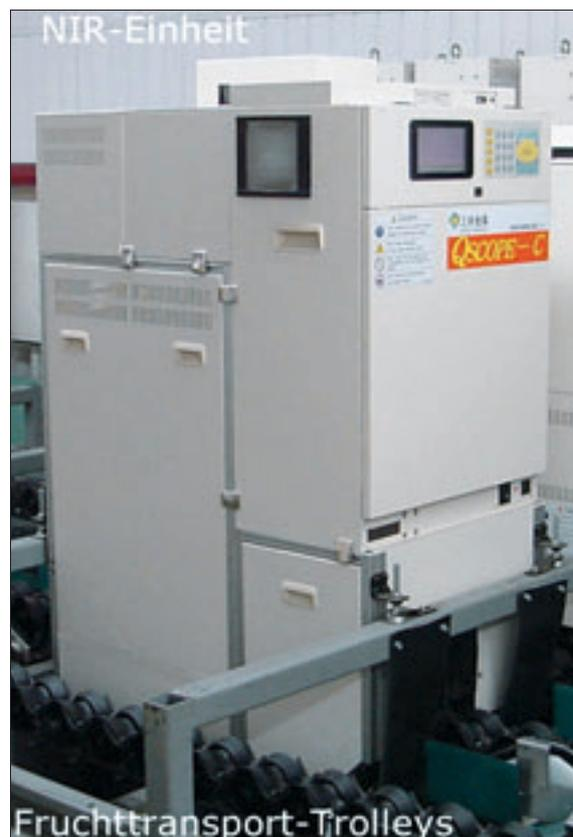
Abb. 1: Sortieranlage, basierend auf der NIR-Spektralanalyse.
