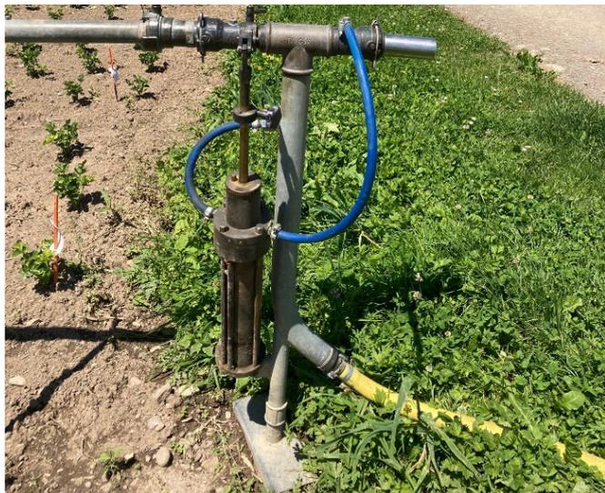
Abb.1: FEKO-Schwenkregner-Motor des Versuchsbetriebs (Foto: Agroscope).
