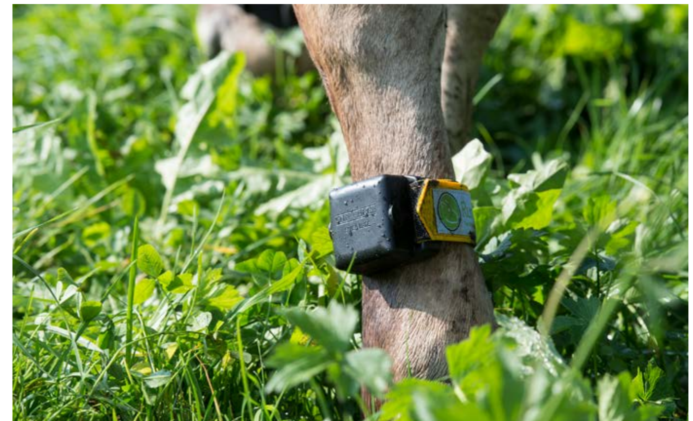
Abbildung 3: RumiWatch Pedometer zur Messung der Bewegungsaktivität der Tiere (Foto: Gabriela Braendle, Agroscope).
