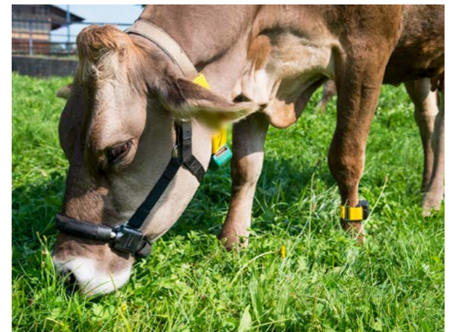
Abbildung 1: Kuh mit RumiWatch Halfter (Itin+Hoch, Liestal, Schweiz) zur Messung des Kauverhaltens, RumiWatch Pedometer zur Messung der Bewegungsaktivität und einem Halsband mit integrierter Tieridentifikation (GEA, Düsseldorf, Deutschland). (Foto: Gabriela Braendle, Agroscope).
