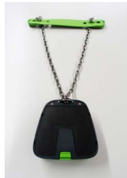
Abbildung 1: Halsband des Virtuellen Zaunsystems von Nofence (Nofence Grazing Technology, Firma Nofence AS, Batnfjordsøra, Norwegen) mit integriertem GPS. Auf der Unterseite (in Grün) befindet sich der austauschbare Akku. Über die Kette werden die elektrischen Impulse abgegeben (Foto: Joanna Stachowicz, Agroscope).
