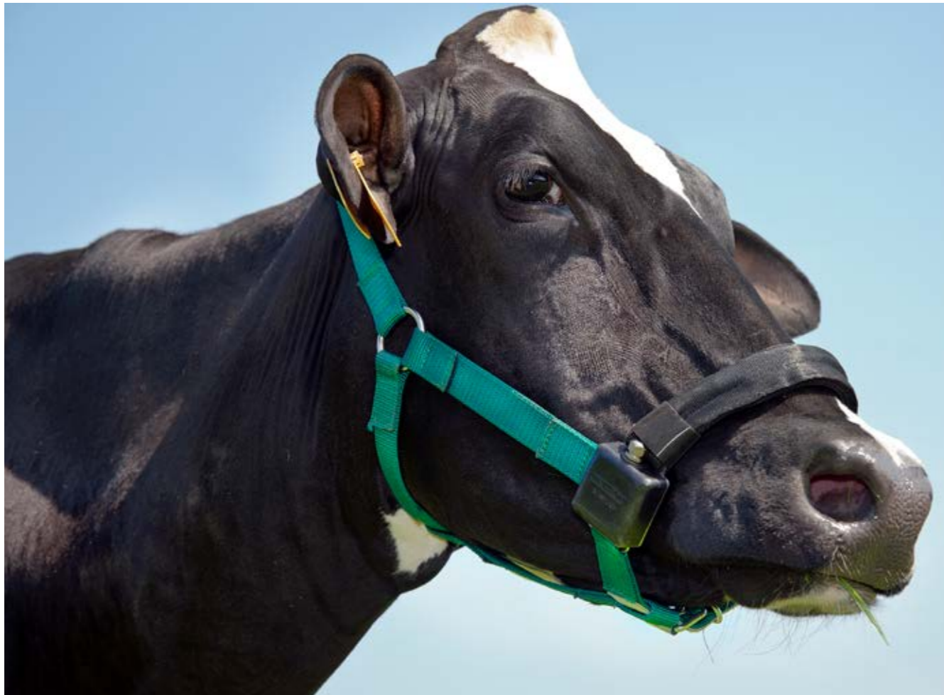
Kuh mit RumiWatch Halfter zur Messung des Kauverhaltens (Foto: Gabriela Braendle, Agroscope).
