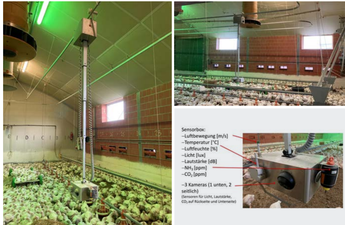
Abbildung 1: Farmer Assistenz System (FAS), auch „Chickenboy“ genannt, auf der Laufschiene in einem Broilerstall (Fahrtrichtung nach rechts) und unten angebrachter Sensorbox (Fotos: Jörg Hartung).
