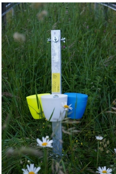
Abbildung 35 Eine Pantrap-Falle im Rebberg, bestehend aus drei Farbschalen an einem Stahlpfosten. Die Höhe der Farbschalen wurde dem Blütenhorizont angepasst.
