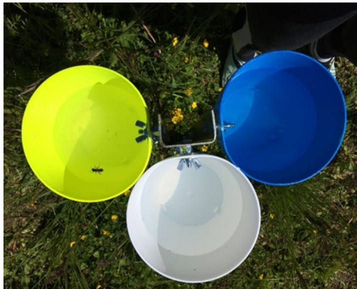
Abbildung 35 Eine Pantrap-Falle im Rebberg, bestehend aus drei Farbschalen an einem Stahlpfosten. Die Höhe der Farbschalen wurde dem Blütenhorizont angepasst.
