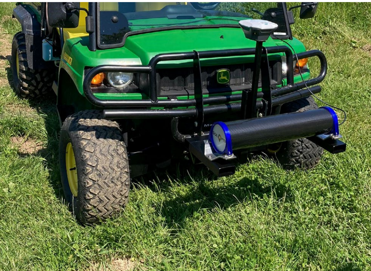
Der Bodensensor kann an ein Trägerfahrzeug, zum Beispiel einen Gator, montiert werden. Bild: Agroscope
