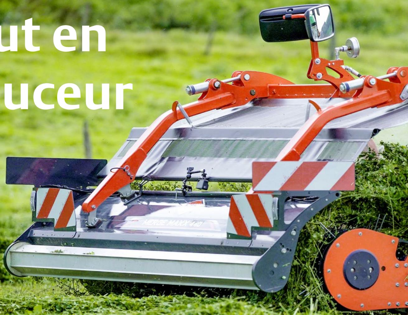
Les andaineurs à tapis deviennent plus courants dans la chaîne de récolte du fourrage. Des solutions techniques permettent de reprendre l'herbe ou le foin proprement au sol pour le transporter via un tapis. Une machine frontale permet en plus de ne pas rouler sur la récolte et de limiter les pertes par émiettement.
