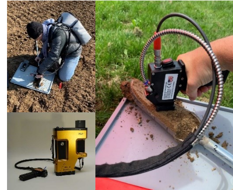
PSR+ 3500 vis-NIR Spektrometer (350-2500 nm, 2.8-8 nm Auflösung)
