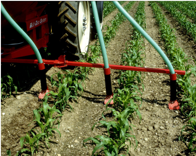
Abbildung 3 | Pflanzennahe oberflächliche Ausbringung eines Mineraldüngers mit Hilfe eines Reihenstreugeräts (Foto: Agroscope).
