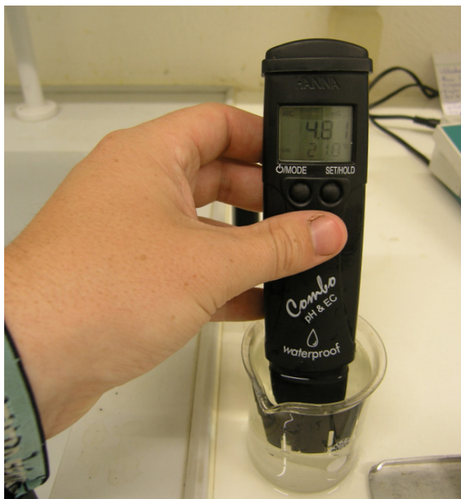
Abbildung 5 | Messen des pH-Wertes und der Leitfähigkeit (EC) der Nährlösung (Foto: Agroscope).
