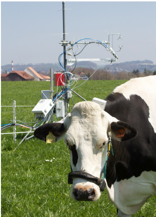
Abbildung 2 | Messung der Lachgasemission in einem Weideversuch mittels der Eddy-Kovarianz-Methode (Foto: Raphael Felber, Agroscope).
