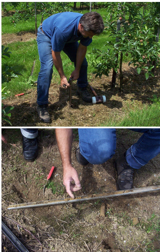
Abbildung 2 | Pro Parzelle werden mit einem Bodenbohrer 12–20 repräsentative Proben in Tiefen von 2–25 cm und 25–50 cm entnommen (Fotos: Andreas Naef, Agroscope).
