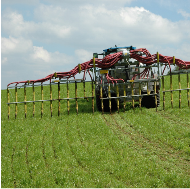
Abbildung 1 | Streifenförmige Ausbringung von Gülle mit einem Schleppschlauchverteiler in einen Wiesenbestand (Foto: Agroscope).
