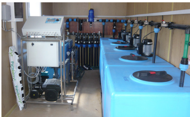
Abbildung 5 | Automatische Mischanlage zur Herstellung der angepassten Nährlösung für Beeren auf Substrat (Foto: Agroscope).
