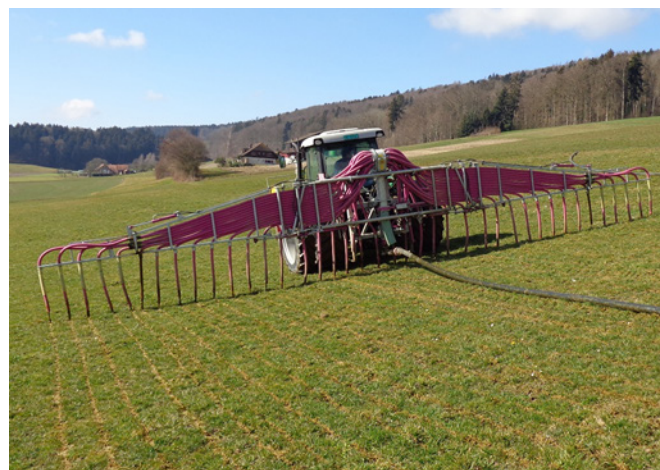
Abbildung 1 | Mit Hilfe von Schleppschauchverteilern mit bodennaher, streifenförmiger Ablage von flüssigen Düngern können Ammoniakverluste im Vergleich zu breitflächiger Ausbringung mit Pralltellern verringert werden (Foto: Harald Menzi, Agroscope).
