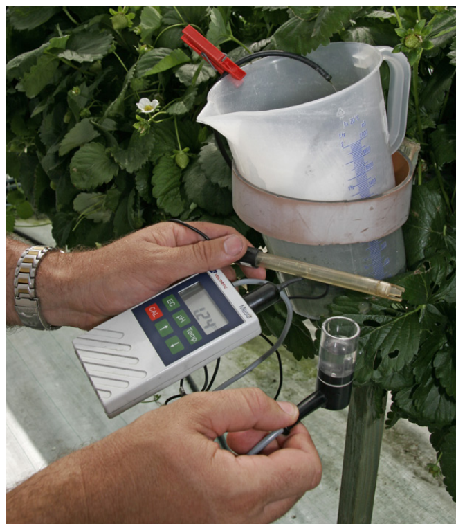
Abbildung 6 | Kontrolle des pH- und des EC-Wertes der Nährlösung (Foto: Agroscope).
