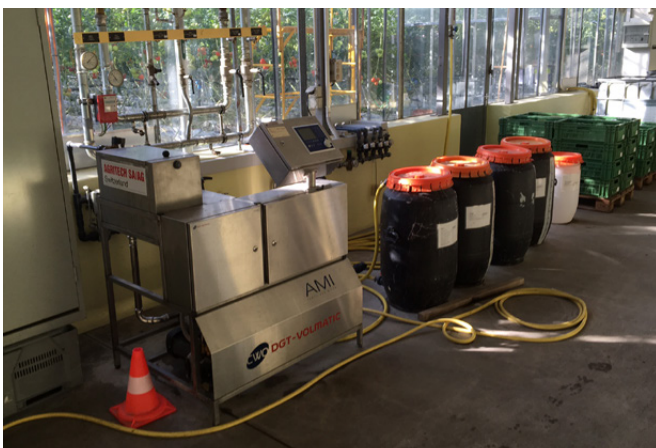
Abbildung 4 | Computer für die Mischung und Steuerung der Düngung von Substratkulturen (Foto: Agroscope).
