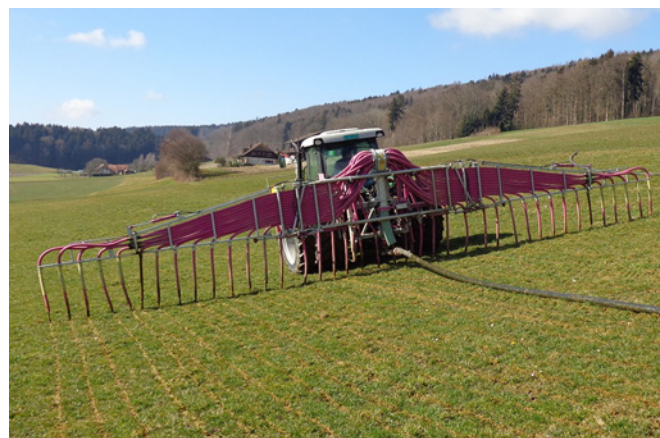
Figure 1. Avec la rampe d'épandage à pendillards, les engrais liquides sont déposés au sol, en bandes étroites, avec peu de pertes, comparativement à l'épandage au moyen d'un déflecteur (photo: Harald Menzi, Agroscope).
