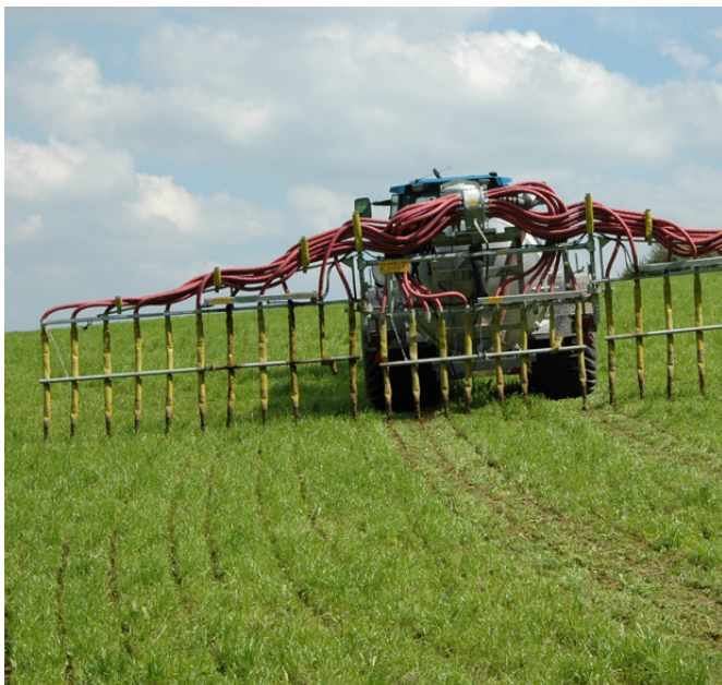
Figure 1. Epandage du lisier en bandes sur une prairie à l'aide d'une rampe d'épandage à pendillards (photo: Agroscope).
