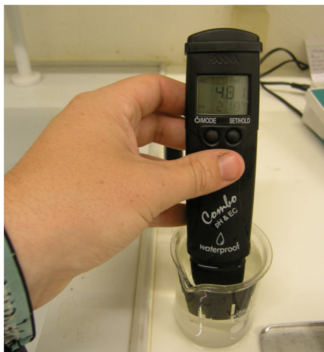
Figure 5. Mesure du pH et de l'électroconductivité (EC) de la solution nutritive (photo: Agroscope).
