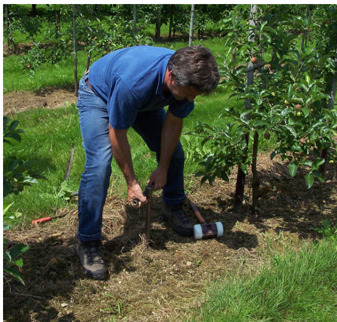
Figure 2. Avec une tarière, on prélève 12–20 échantillons représentatifs par parcelle à des profondeurs de 2–25 cm et 25–50 cm (photo: Andreas Naef, Agroscope).
