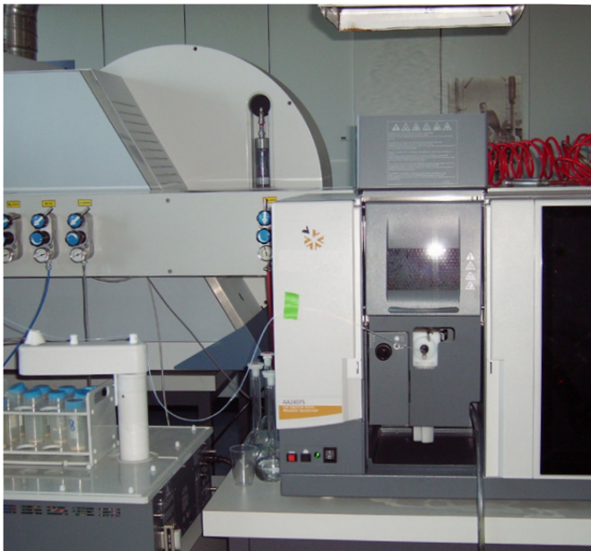
Figure 5. Détermination de divers éléments par spectrométrie en absorption atomique (AAS) (photo: Diane Bürge, Agroscope).
