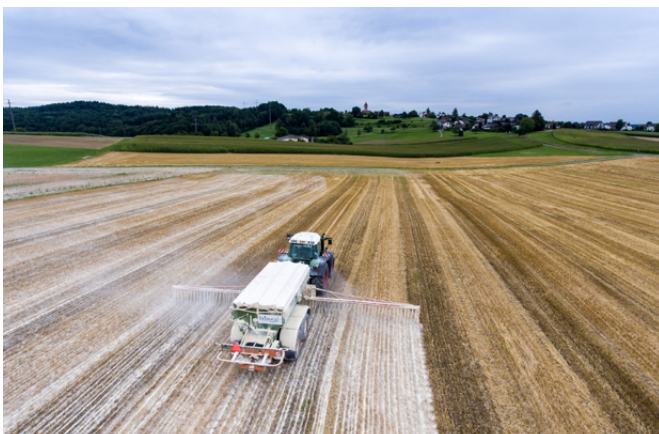
Une technique adéquate permet un dosage exact et la distribution uniforme des amendements calciques (photo: Peter Briner AG).
