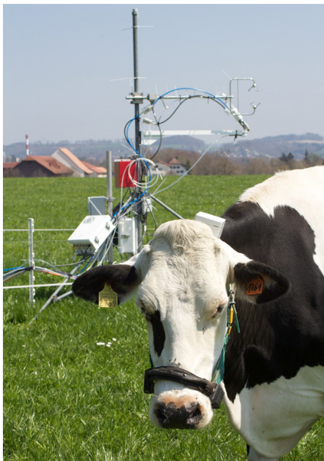
Figure 2. Mesure des émissions de protoxyde d'azote dans un essai de pâture au moyen de la méthode Eddy covariance (photo: Raphael Felber, Agroscope).
