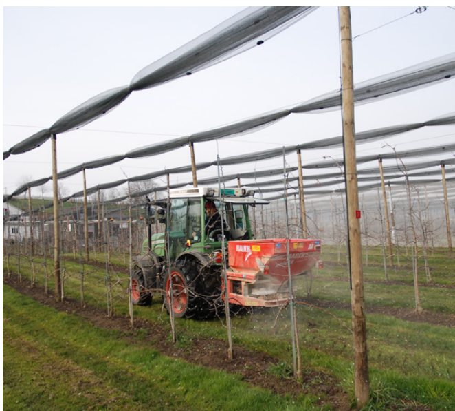
Figure 11. Semoir à engrais: fertilisation distribuée dans tout l'espace occupé par les racines ainsi que sur les interlignes (photo: Thomas Kuster, Agroscope).
