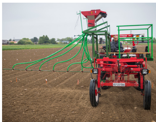
Apport d'engrais différenciés sur la culture de pomme de terre (photo: Agroscope).
