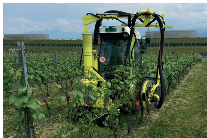
ABBILDUNG 1. Entblätternsgeräts mit doppeltem Niederdruck-Luftstrom (Collard, Bouzy, Frankreich) in Aktion im Stadium vor der Blüte (Geschwindigkeit 0,6 km/h). Cultivar Gamay, Nyon, Schweiz.
