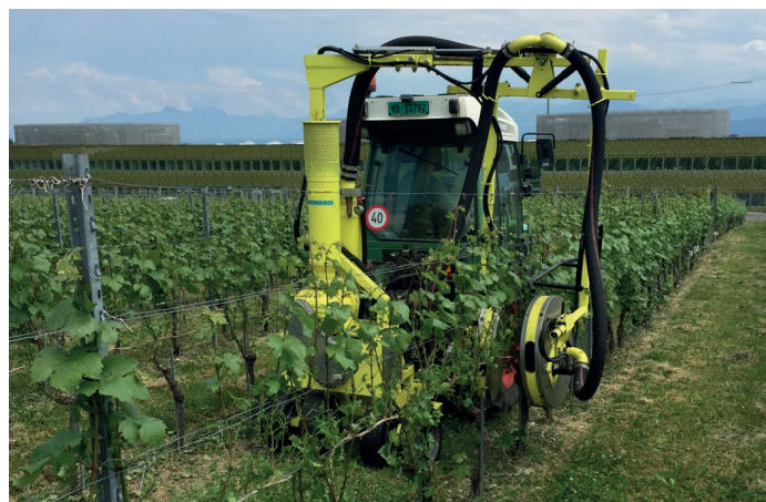
FIGURA 1. Defoliadora de doble flujo de aire a baja presión (Collard, Bouzy, Francia) en acción durante la etapa prefloral (velocidad 0,6 km/h). Cultivar Gamay, Nyon, Suiza.
