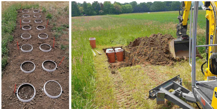
Abbildung 10: Installation von Feldlysimetern in Oensingen im Mai 2023. Vier verschiedene Böden (zwei aus dem Ackerbau und zwei aus dem Gemüsebau) werden viermal in 25 cm tiefen Lysimeter repliziert.
