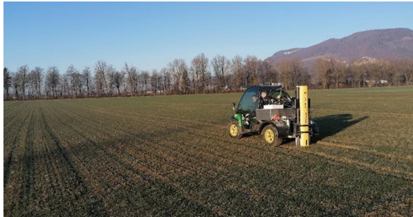
Abbildung 2: Mechanische N_{min} -Probenahme. Pro Feld oder Sektor werden 12-15 Einstiche auf der Fläche in drei Horizonten (0-30 cm, 30-60 cm, 60-90 cm) vorgenommen. Probenahme am 25.02.2022 durch Sven Schönmann (Briner AG), Probenehmer im Nitratprojekt.
