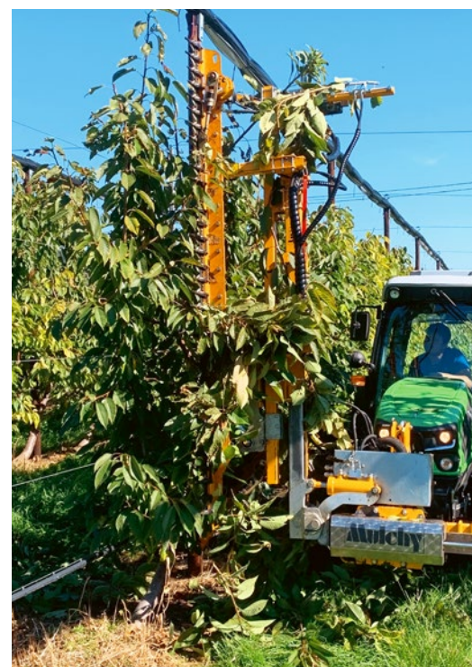
Abb. 2: Mit dem Plantagenschneider «Mulchy CRF» wurden im Spätsommer die Seitentriebe eingekürzt. (© Agroscope)
