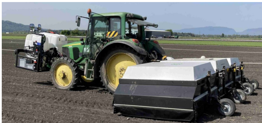
Foto 1: lotta alle malerbe con l'ARA di ecorobotix (foto: Michael Gugger, Stazione sperimentale Orticoltura Ins, Agroscope).
