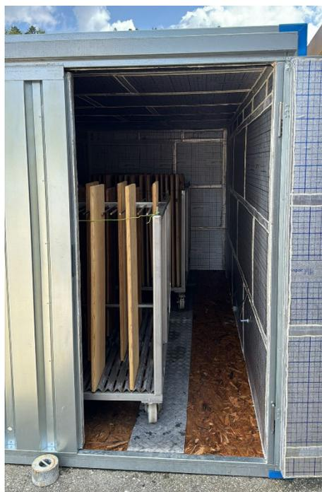
Figure 11: exemple de cellule à vapeur fonctionnant à l'aide d'un appareil servant au désherbage par la chaleur.
