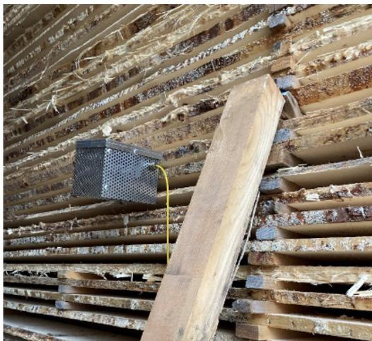
Figure 8: contrôle de l'humidité des tablards
