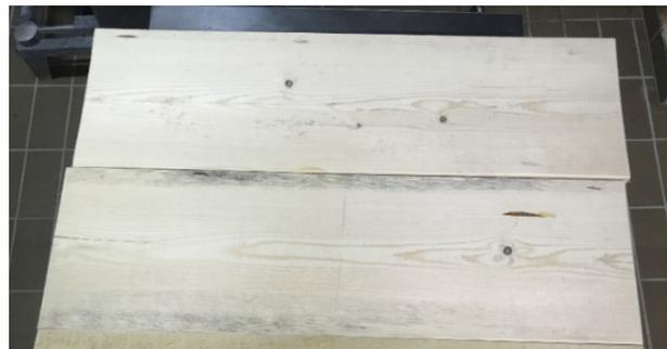
Figure 14: tablards neufs avec 37 % d'humidité contaminés par des moisissures noires.
