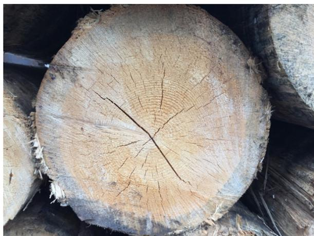
Figure 3: bleuissement du bois provoqué par des moisissures
