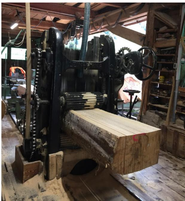
Figure 7: délignage des planches
