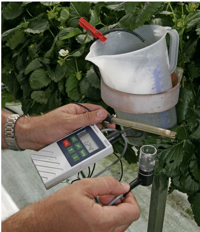
Figura 6. Verifica dei valori di pH e di EC di una soluzione nutritiva.
