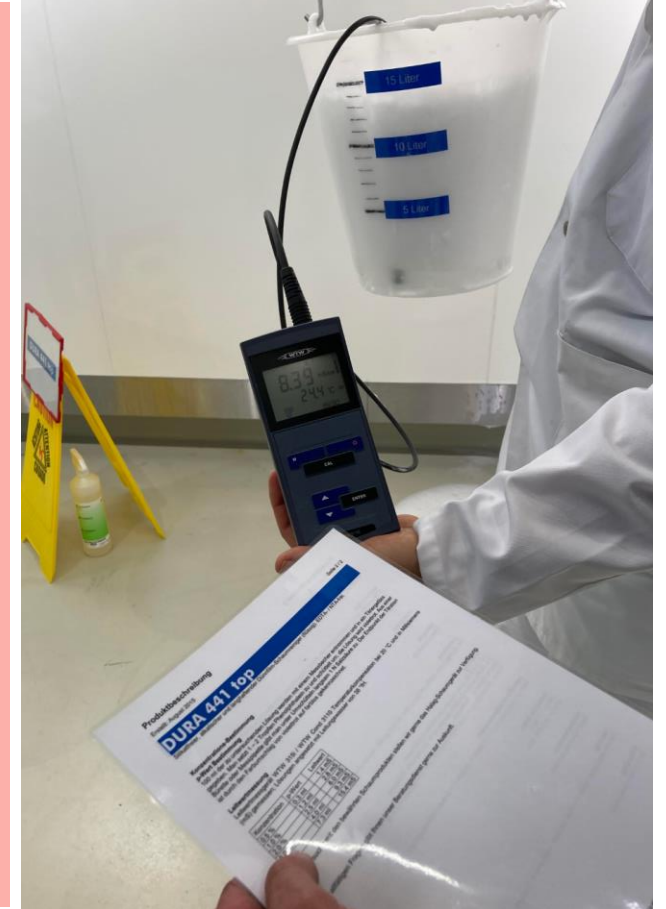
La fiche technique de Halag permet de faire la conversion entre les mS, valeur p et la concentration du produit en %.
