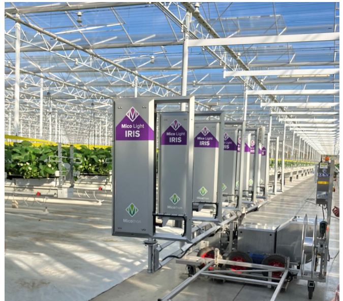
Robot UV-C che permette di trattare sei file in un solo passaggio.
