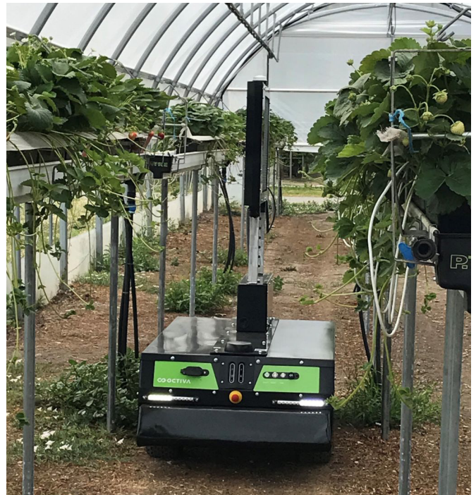
Robot UV-C adatto a tutti i tipi di terreno per l'uso in tunnel con fragole coltivate su bancali.
