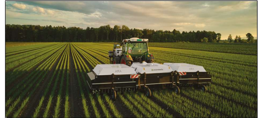
Ecorobotix-ARA: 3x 52 Düsen zur Behandlung von Einzelpflanzen
