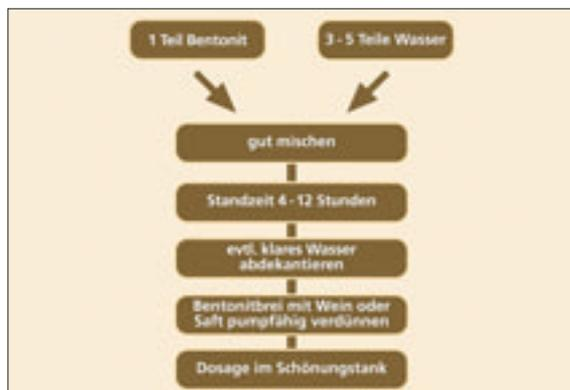
Abb. 4: Vorquellung von NaCalit® PORE-TEC.
