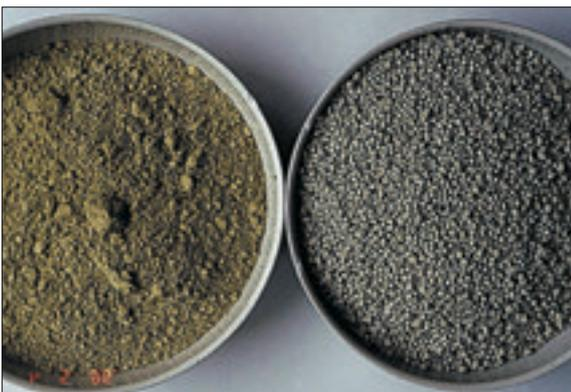
Abb. 3: Bentonit als Pulvergranulat.
