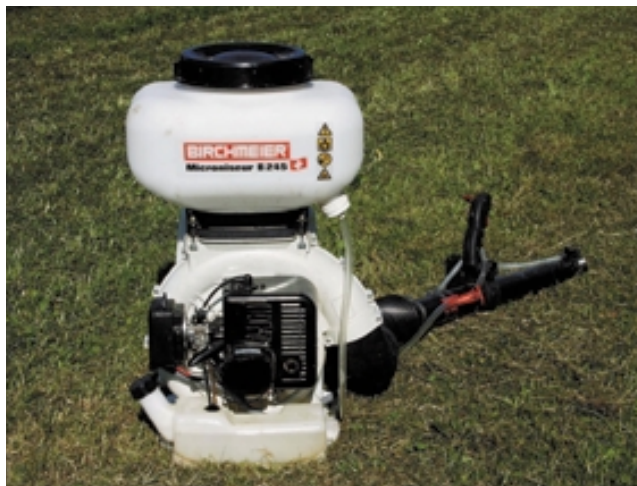
Abb. 1: Microniseur B245 der Firma Birchmeier mit gutem Trag- und Bedienungskomfort. Der Membranvergaser ergibt ein gutes Kalt- und Warmstartverhalten.
