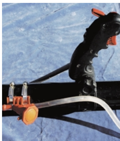
Abb. 3: Microniseur B245: Die übersichtliche Anordnung der wichtigsten Bedienungselemente im Sichtbereich des Operators ist praktisch. Die Motor- und damit die Luftleistung ist am Revolvergriff dosier- und arretierbar. Einrastbare Einstellungen des Gashebels wären zusätzlich wünschenswert. Der rote Hahn dient dem An- und Abschalten des Brühezufusses. Ein Zweiweghahn, anstelle eines Drehhahnes wäre noch praktischer.
