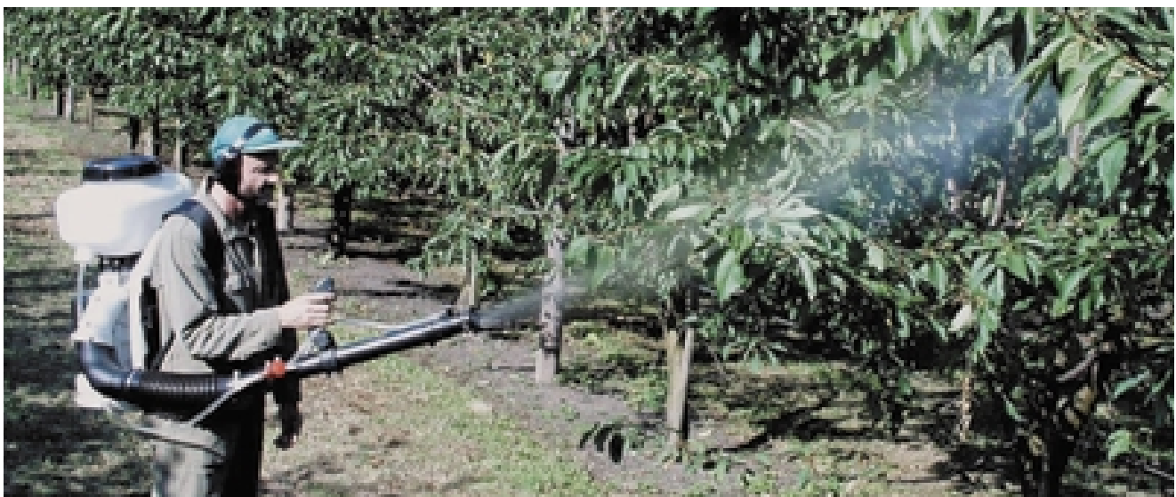
Abb. 8: Bei voller Motorleistung können mit dem Microniseur B245 Bäume bis zu einer Höhe von 5,0 Meter wirksam besprüht werden. Der Tankdeckel muss gut dichten (Moosgummidichtung) und ganz zuge dreht sein, damit der nötige Überdruck erzeugt werden kann. Das Blasrohr sollte nicht zu steil gehalten werden, damit die volle Sprühleistung erzielt werden kann; im Bild Halbstammkirschen. Demonstrations-Sprühgeräteinsatz mit Wasser als Sprühmittel. Im praktischen Einsatz unbedingt Anwenderschutz beachten (siehe Seite 2).
