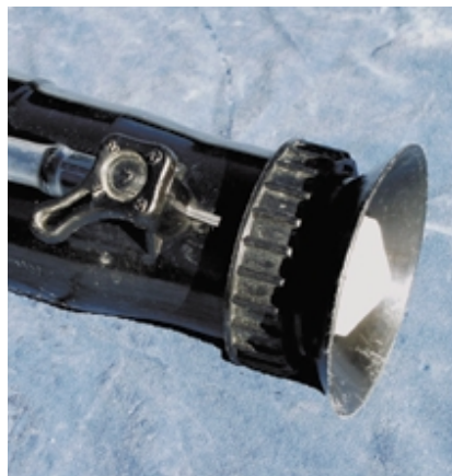
Abb. 2: Microniseur B245: Mit dem kleinen, schwarzen Hahn wird die Durchflussmenge reguliert (siehe Tab. 1). Ein spürbares Einrasten in den vier Positionen wäre zusätzlich wünschenswert. Der Öffnungswinkel des Sprühstrahls lässt sich durch Vor- und Zurückschieben des trichterförmigen Mundstücks verkleinern beziehungsweise vergrössern.
