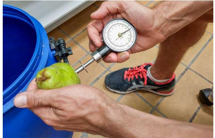
Abb. 1: Messung der Fruchtfleischfestigkeit mittels Penetrometer.
