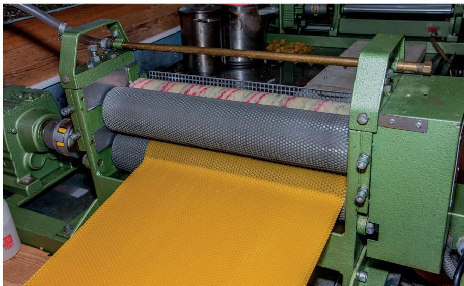
Figure 1 : Fabrication de cires gaufrées
